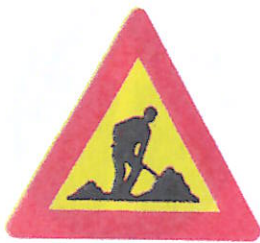
(K - 20) Κίνδυνος λόγω εκτελουμένων εργασιών στην οδό.
